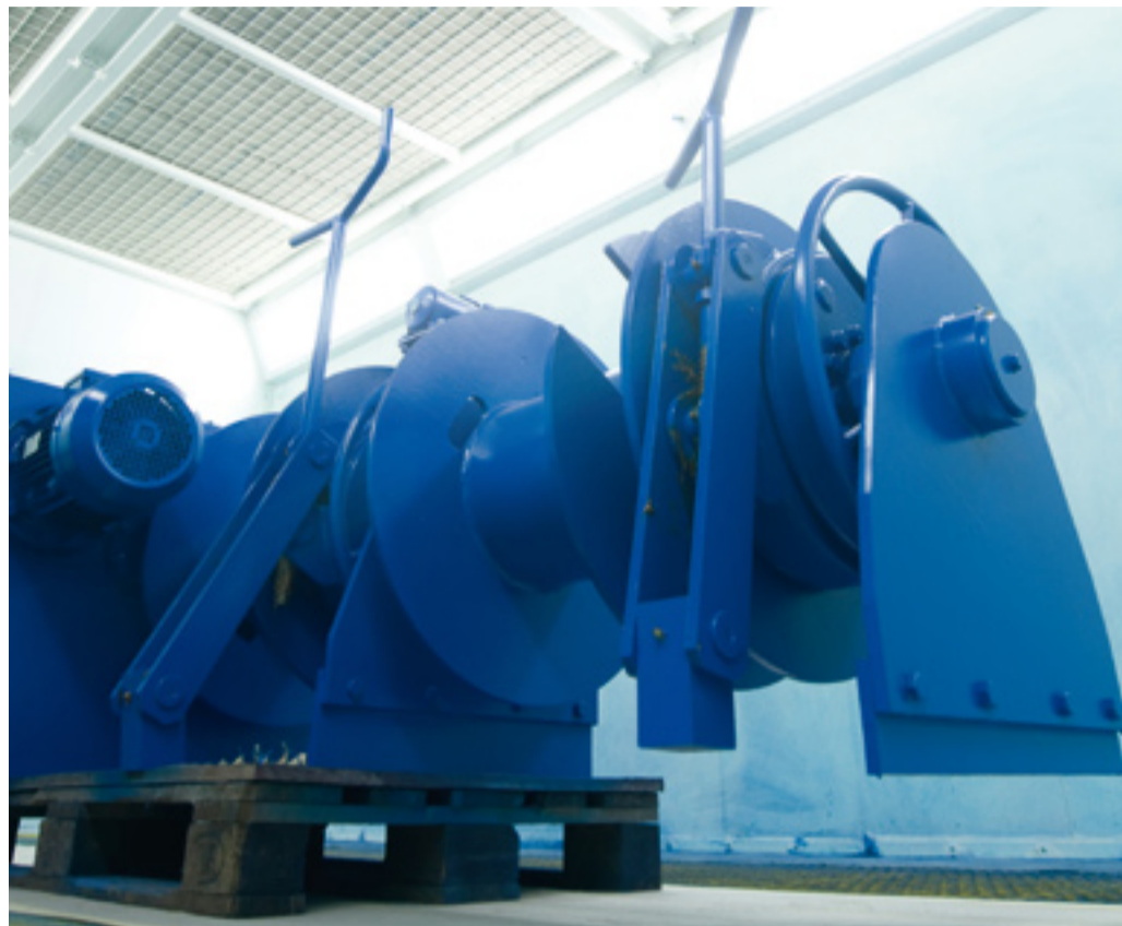
Die Winden, Rollen und Klampen von Steger & Windhagen sind für die Binnenschifffahrt gedacht und erhalten mittels Speziallacke einen entsprechenden Korrosionsschutz. Quelle: Primagas
